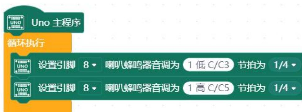
下载程序完成后，你会听到一高一低的报警声，如同汽车报警器。
