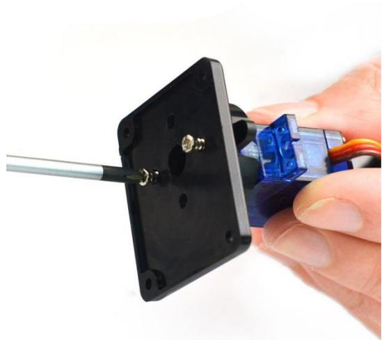
4. 将云台两个侧翼相对安装在舵机上。
