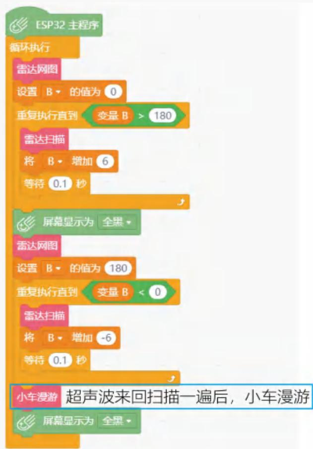
运行结果：上电后，舵机带动超声波 0-180 度扫描后，再 180-0 度扫描，同时在屏幕上显示雷达图。扫描一个来回后，小车“智能”行走，可以自行躲避障碍。
