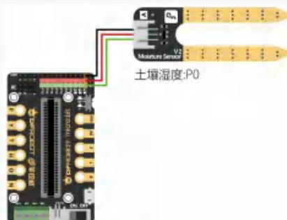
测试程序：将土壤湿度传感器测量的湿度显示在屏幕上。
