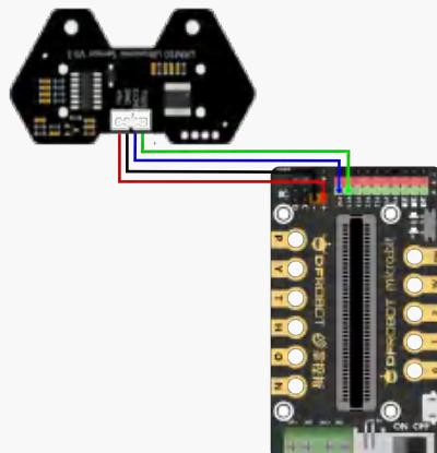
\* 这里要将掌控行板插入扩展板中（带有 OLED 屏的一面，朝向扩展板上掌控行板图标），为了便于看清连线，在图中画未出掌控行板。后面连线图都默认连接掌控行板，不再重复说明。
