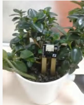
例如使用掌控板、土壤湿度传感器可以做一个简易土壤湿度显示器，结合电路知识，电路图简化如下。从电路图可以看出，这里的土壤湿度传感器相当于开关，当两金属条插入到土壤中后，相当于电路导通。
