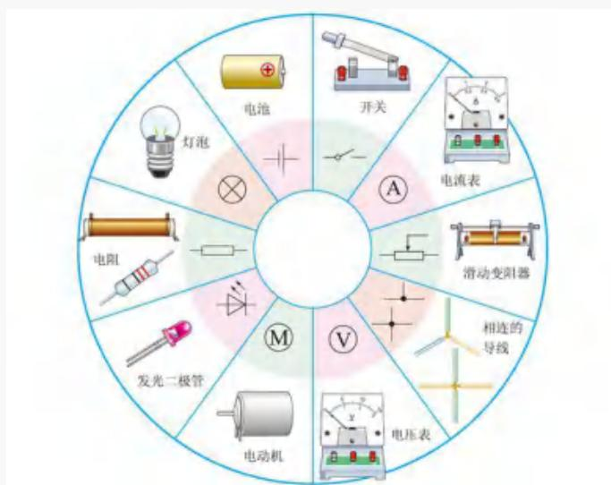
用简化后的元件图标就可以**快速绘制电路图**。如下图为简化的手电筒电路图。
