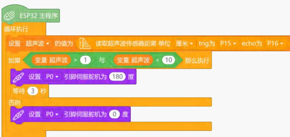
运行结果：超声波感应到 10cm 以内的障碍物时，舵机转到 180 度，3 秒后回转到 0 度。
