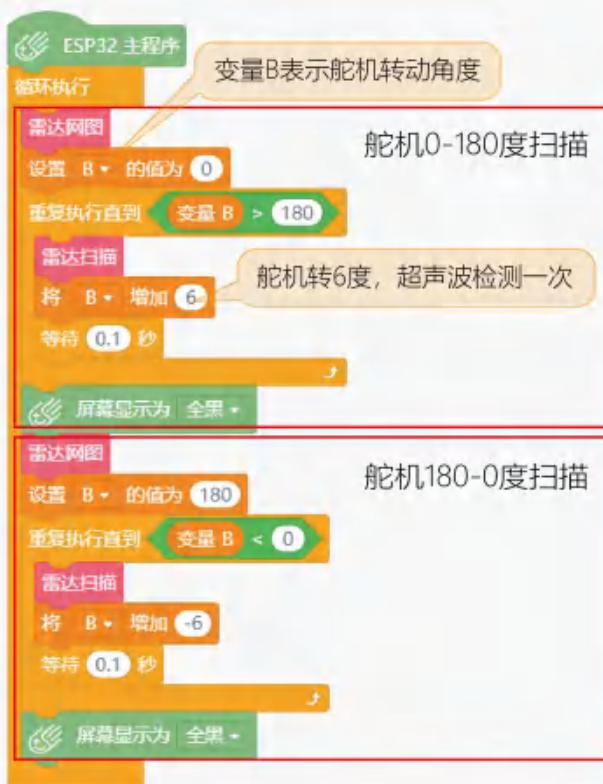
运行结果：将超声波固定在舵机上（可将胶带或胶枪固定），超声波随着舵机来回转动，在 5-60cm 范围内，如果有障碍，屏幕上将画出白线。
