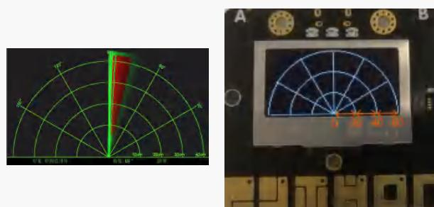
如何显示扫描的障碍呢？考虑到掌控板屏幕小、分辨率低、且只有黑白屏，所以这里采用画线的方式显示障碍。如下图，无白线的区域表示没有障碍，有白线的表示有障碍，线的长短代表障碍距离的远近，线越短，说明距离越近！
