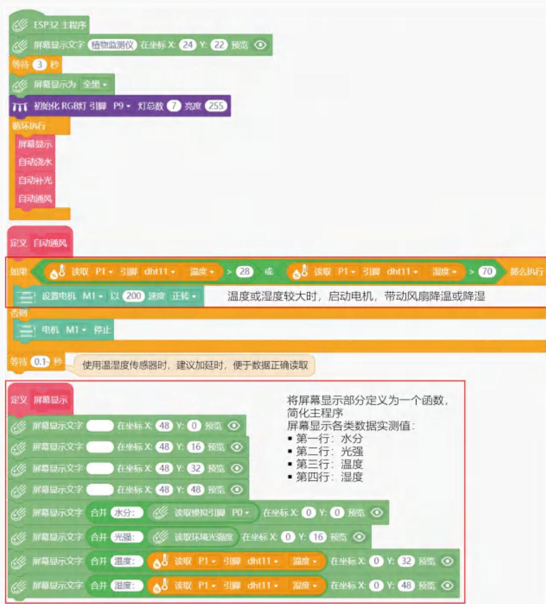
运行结果：屏幕显示实测土壤湿度、光线强度、空气温湿度；当温度或湿度较高，启动电机。
