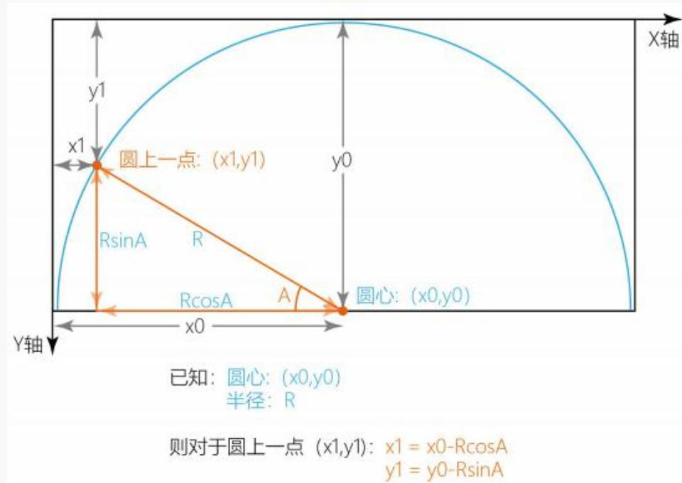
当超声波探测距离 R 随舵机角度 A 实时变化，根据上面的数学关系，障碍物位置坐标  $(x_1, y_1)$  也会实时变化。
