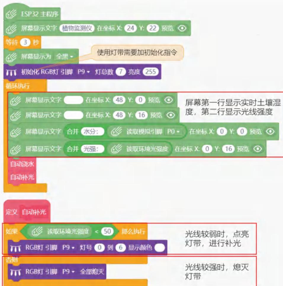
运行结果：屏幕显示实测土壤湿度值、光线强度值；当光线较弱时，点亮 RGB 灯带。
