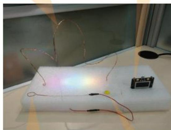
铜丝结合杜邦线的套环模型
