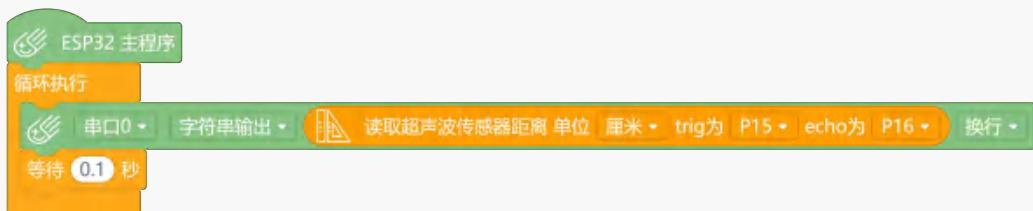
功能程序：超声波每次检测到障碍物，算作进球一次，将得分实时显示在屏幕上
