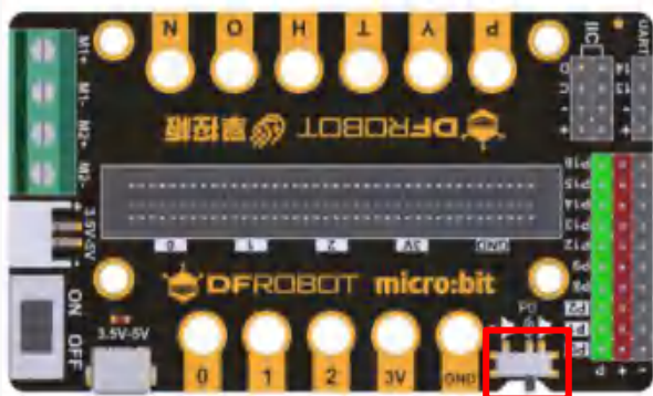
图 1.3.1 蜂鸣器开关打开示意图
