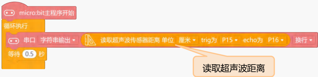
图 3.1.3 串口读取超声波距离
