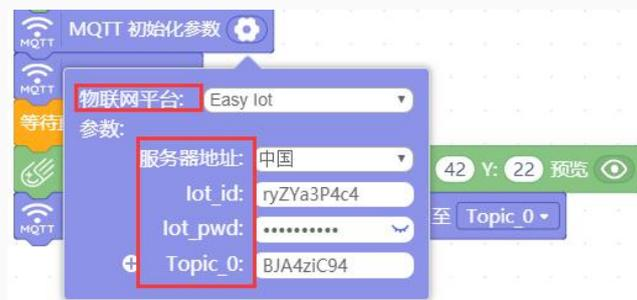
3、通过使用物联网，主人可在电脑或手机端发送指定消息，实现远程投喂，这里我们选择 Easy IoT，注意关于 WiFi 和 MQTT 具体参数的设置按照自己本身的进行设置。
