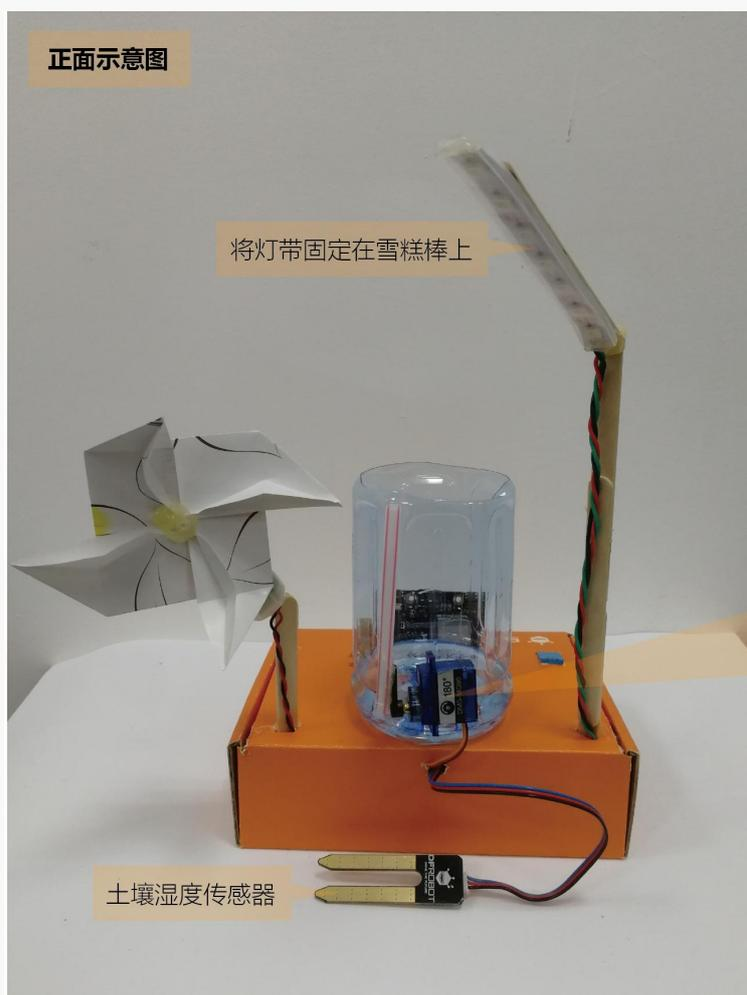
用热熔胶将舵机固定在瓶子上，摇臂固定吸管出水端
