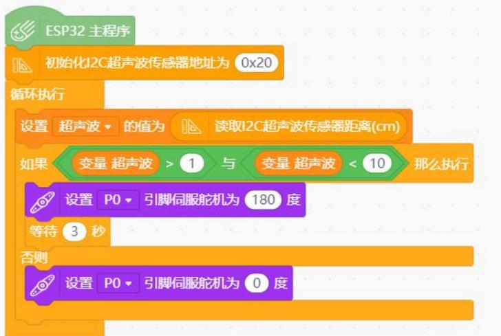
运行结果：超声波感应到 10cm 以内的障碍物时，舵机转到 180 度，3 秒后回转到 0 度。
