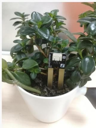
例如使用掌控板、土壤湿度传感器可以做一个简易土壤湿度显示器，结合电路知识，电路图简化如下。从电路图可以看出，这里的土壤湿度传感器相当于开关，当两金属条插入到土壤中后，相当于电路导通。
