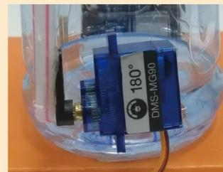
在塑料瓶底部侧边开一个洞，插入吸管，用热熔胶封口
