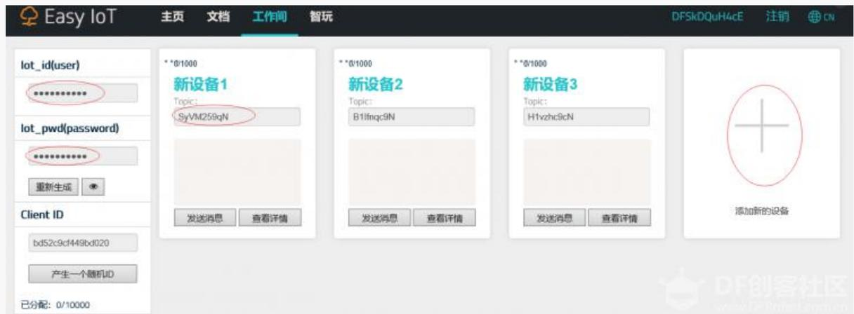
(图中标记的参数需要对应填入到 mind+ 的 MQTT 初始化 block 中。)
