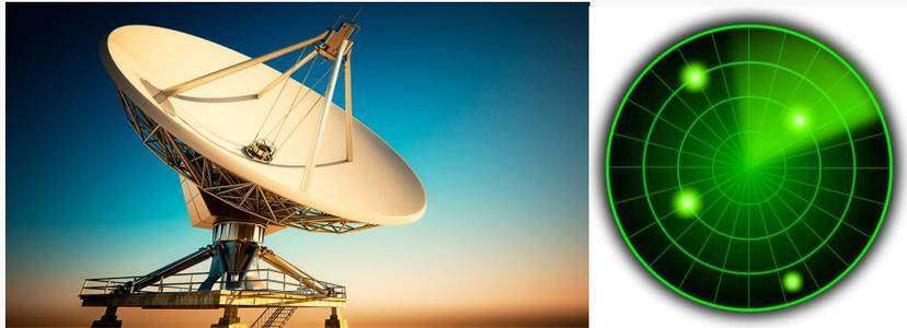
有的雷达可以 360 度转动，用于定位附近的障碍物的距离和方位，并将数据传回电脑，通过雷达扫描图来实时显示。图中绿色圆点即为检测到的障碍物。
