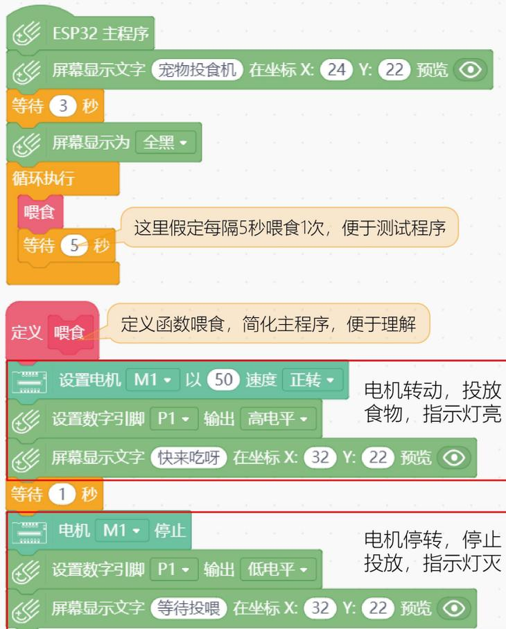
运行结果：每隔 5 秒，电机转动 1 次。“喂食”函数中定义电机以 50 的速度转动 1 秒，后面项目实现过程中可根据实际需求进行修改，结合外观构建达到最佳的效果。
