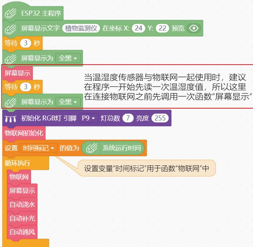
**定义 物联网初始化** WiFi和Easy IoT连接设置，注意对应填写自己的WiFi和Easy IoT信息
