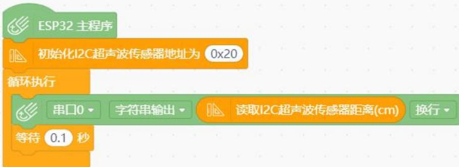
功能程序：超声波每次检测到障碍物，算作进球一次，将得分实时显示在屏幕上
