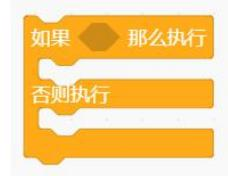
①根据上一个小贴士的提示，我们可以进行初步的设计啦：将“控制”代码模块中的条件语句“如果--否则”拖动至脚本区，将“运算符”中的“<”拖动至脚本区。
