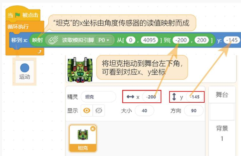
点击绿旗或程序块运行程序。运行结果：转动旋钮，“坦克”随转动方向左右平移。
