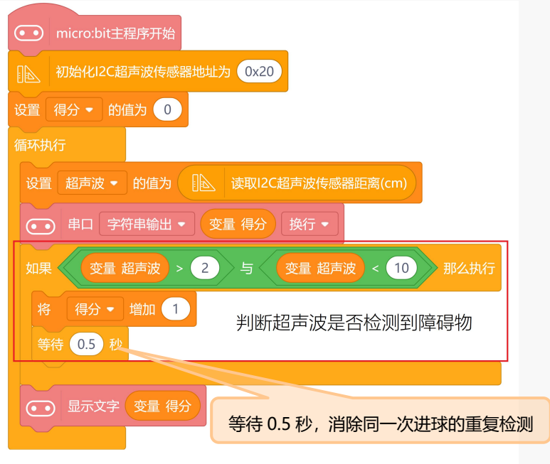
图 3.1.4 超声波检测障碍物
