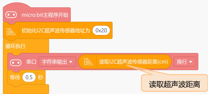
图 3.1.3 串口读取超声波距离
