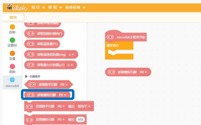
图 1.4.15 “读取模拟引脚” 指令
