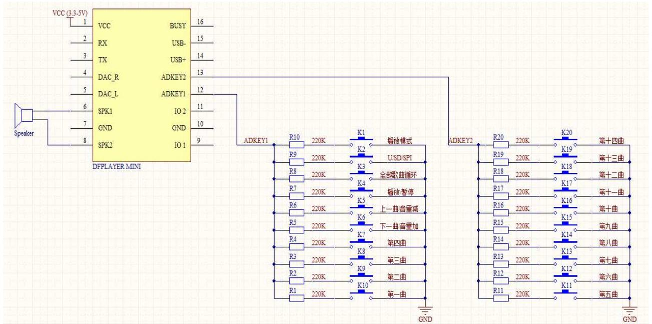
图 4.5 模块接 AD 按键使用示意图
