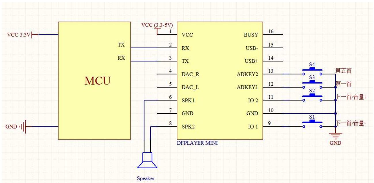
图 4.1 扬声器、MCU 3.3V、串口、按键接线图
