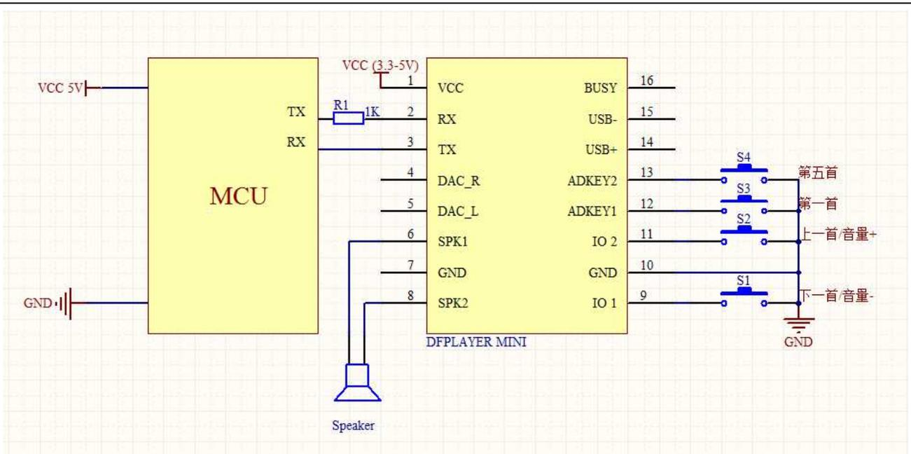
图 4.2 扬声器、MCU 5V、串口、按键接线图
