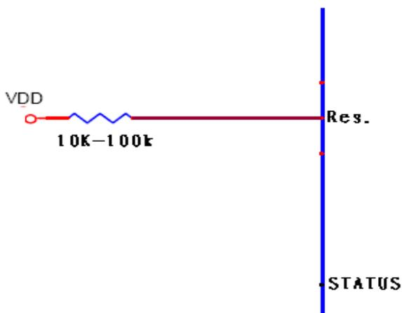
注: 也可以考虑和复位引脚 RST 的接法类同, 配置一个较小的电容 (其它组电源配置较大的电容), 使得 SYN6288 各组电源供电前, Res. 引脚能置为高电平! 这样可以有效防止外部电源的突发性干扰。
