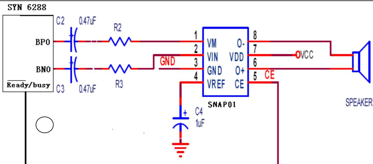
注：在这种情形下，每次开启功放电路 SNAP01 时，在 BNO/BPO 连接耦合电容会有一些放电现象，通过 SNAP01 放大后就会有“波波”的声音！因此，SNAP01 的片选引脚，但是可以节省 MCU 上位机宝贵的 IO 口。
