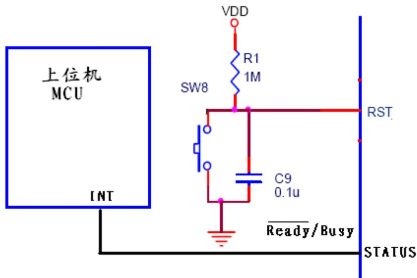
备注：**Ready/Busy** 此STATUS引脚信号为低电平时说明芯片正在等待接收数据。在系统设计时可以将此引脚接在MCU的中断输入源上，产生一个下降沿中断请求发送数据，以示上位机MCU可以向语音合成芯片发送数据。
