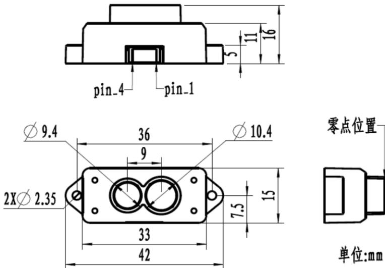
图 1 TF Mini 模块尺寸图
