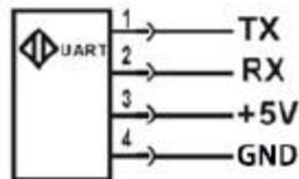
图 2 TFinI 线序图
