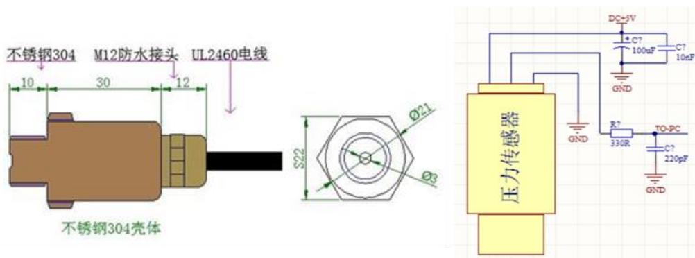
防水等级IP68+3pin直接引线
