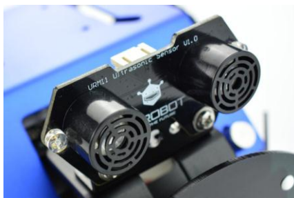
图 3. MAX 身上的超声波传感器
