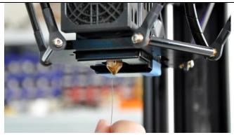
**10**、关闭打印机电源,重新装上之前旋下的导料管。需要注意喷嘴乳白色细管需直插入气动接头,不要弯折。装好电路板。
