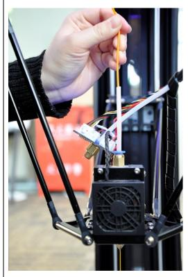
9、如果经过上诉清理无效,使用工具盒内 0.4mm 细铁丝从喷嘴口插入内部疏通喷嘴,此过程需要注意安全,防止烫伤。之后反复进行上一步。
