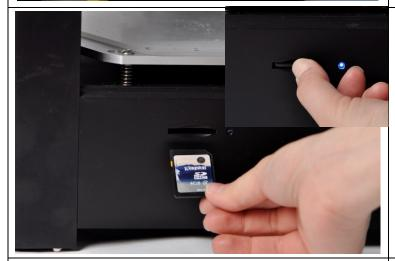
(2)将.stl 模型放入 Cura 中, 并生成打印文件.gcode。考入 SD 卡,插入机身下方卡槽。 SD 卡插入后,蓝指示灯亮。
