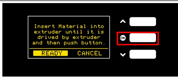
(6) 选择“Ready”，打印机自动控制料进入喷嘴；
