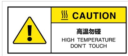
该警示符号表示：贴有该标签的零件在打印机上电时将产生高温，为了您的安全，请不要用身体部位触碰，也不要让易燃易爆物品靠近。
