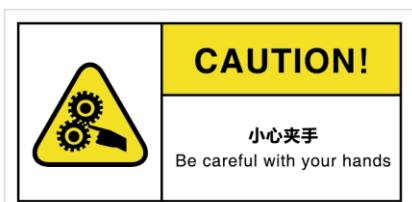
该警示符号表示：贴有该标签的零件在打印机上电时将产生机械运动，为了您的安全，请不要用身体部位触碰，避免受伤。
