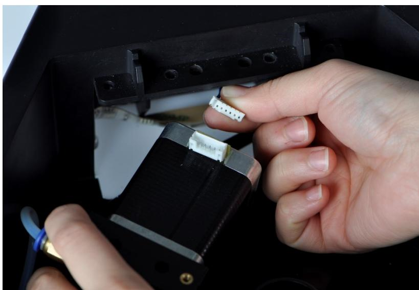
3、拆开挤出机构，在挤出轮处取出断料，注意不要遗失挤出机构内部的 M3 螺丝。
