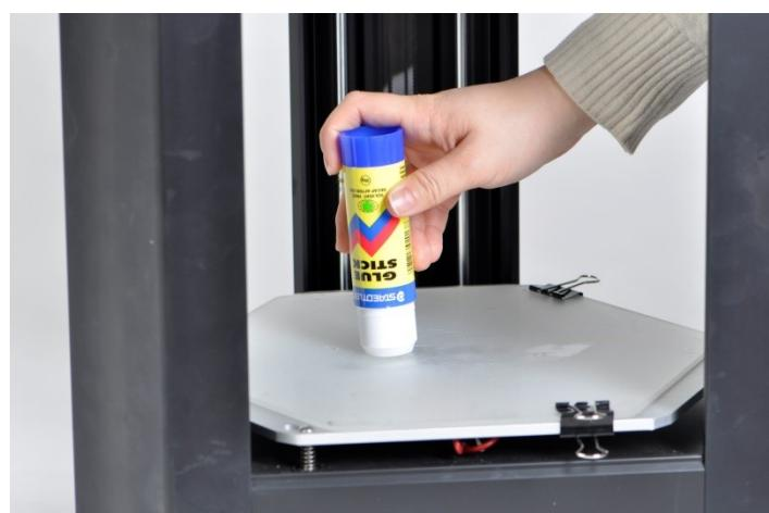
(1) 打印前，保证打印平板上无异物。如果打印平板上有破损固体胶残留物，可用冲洗并用湿抹布去除；平板晾干后，均匀在打印平板上涂抹 3 层固体胶；
