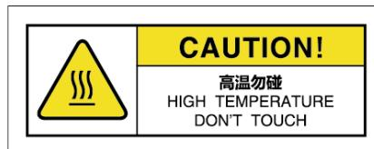
该警示符号表示：贴有该标签的零件在打印机上电时将产生高温，为了您的安全，请不要用身体部位触碰，也不要让易燃易爆物品靠近。
