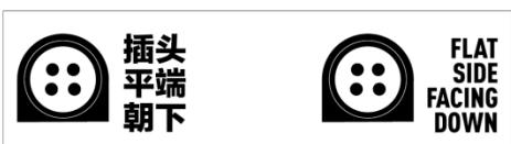
该提示符号表示：贴有该标签的电源适配器接头需要以正确的方向插入打印机。忽视这些指示内容并错误操作产品可能会造成人员伤亡或者产品损坏。
