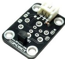
图 2.7.1 LM35 线性模拟温度传感器
