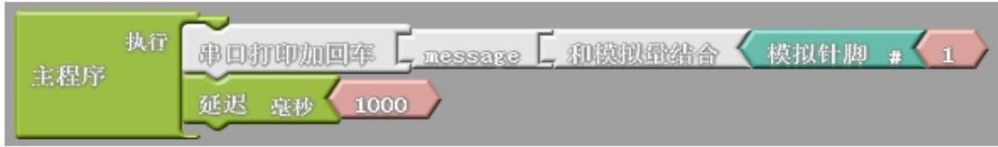
图 2.1.4 读取模拟声音传感器的值
