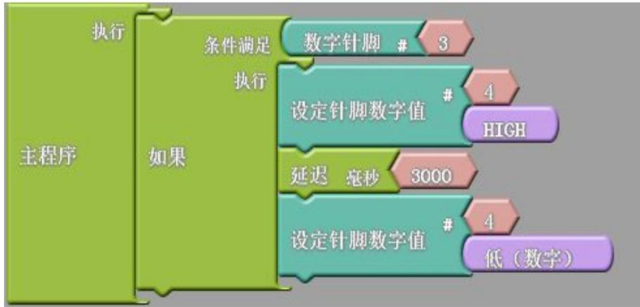
图 1.3.5 按钮按下亮，延时一段时间，自动关闭的 LED
