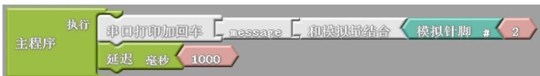
图 1.6.6 串口输出光线传感器的值
