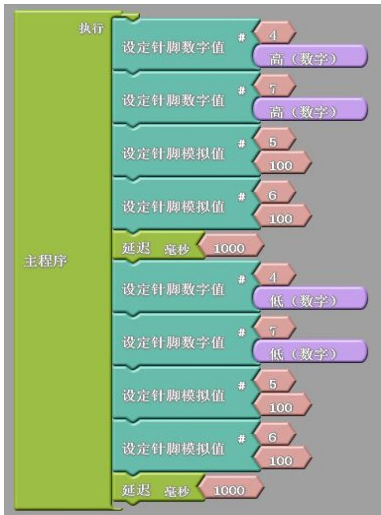
图 3.1.3 引脚控制小车前进、后退
