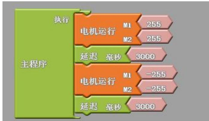
图 3.1.3 电机控制小车前进、后退
