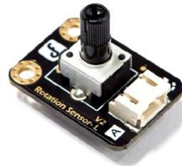
1. 硬件连接：模拟角度电位器→A0；LED→10。注意插线时的颜色对应。
