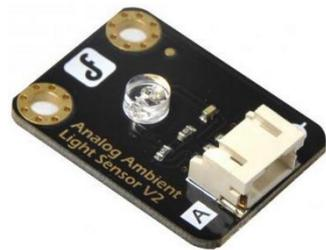
模拟光线传感器可以将周围的亮度转化为模拟信号，输入到 Arduino 主控板上。
