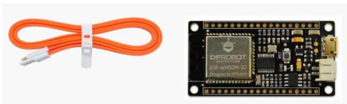
图3 USB 连接线&FireBeetle Board-ESP32 主控
