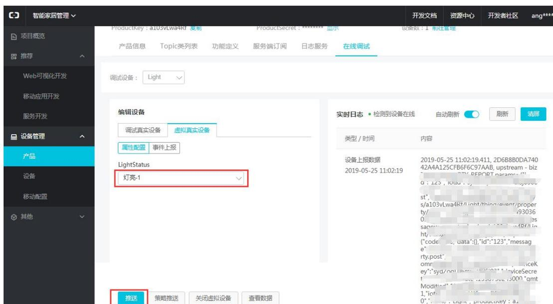
☑收到设备上报数据后，在回到移动应用开发页面，点击**确定**，即可完成“指示灯”的配置了，如果你不知如何配置指示灯可以点击右下角的“如何配置指示灯”，这样就将指示灯链接到“Light”设备上了，当“Light”设备的状态发生改变，“指示灯”控件的状态也会发生改变，如下图所示：
