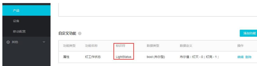
复制粘贴该产品标识符到程序代码相应位置，如下图所示：
