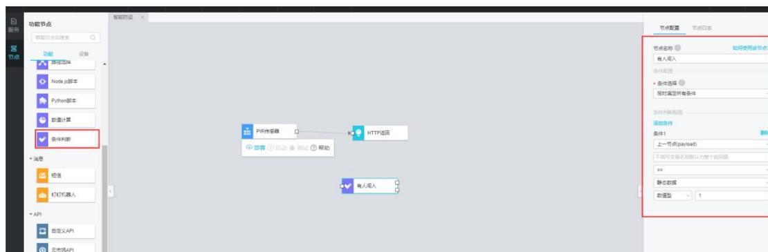
☒删除“HTTP 返回”节点，选中消息->钉钉机器人，添加钉钉机器人节点。并将 PIR 传感器、有人闯入、钉钉机器人节点连接起来。添加两个钉钉机器人。一个要选择是满足条件的接口连接。另一个选择不满足条件的接口。
