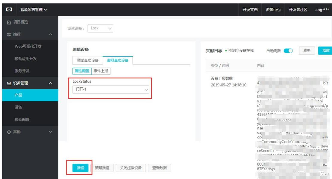
☑收到设备上报数据后，在回到移动应用开发页面，点击**确定**，即可完成“开关”的配置了，如果你不知如何配置开关可以点击右下角的“如何配置开关”，这样就将指示灯链接到“Lock”设备上上了。
