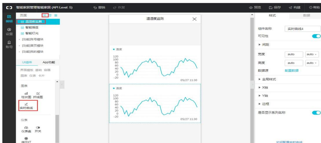
◆配置温度采集。选中其中一个实时曲线，点击**数据->配置数据**，在弹出的选项框里选择相应的选项，并点击确定。
