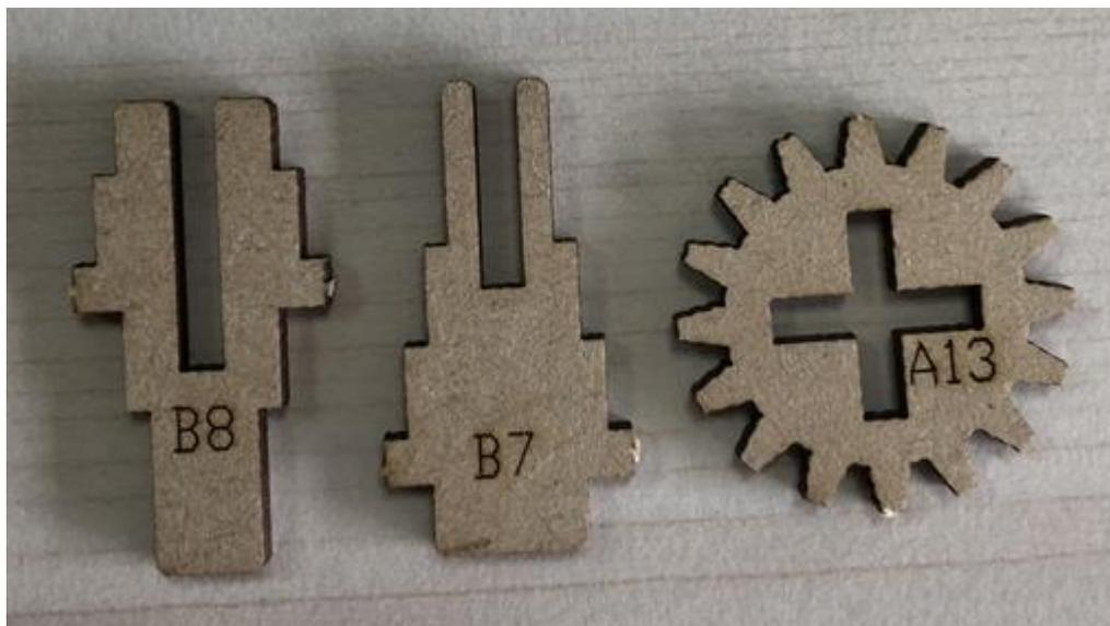
将 A13 套入到 B7 中，然后将 B8 插入到 B7 中，
