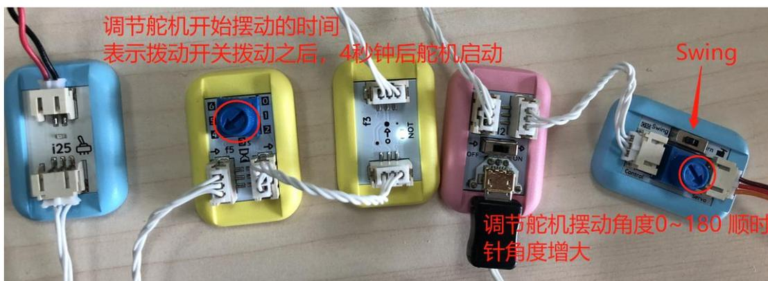
舵机的摆动角度不宜太小，因为会触碰不到拨动开关，达到效果；也不宜太大，会卡住，通过调节舵机控制模块的旋钮，将舵机的角度调节在一个类似直角的位置。
