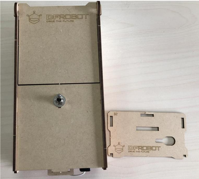
安装的时候，先装下面的位置，将电池盒先拔掉，从 B2 对应的孔位穿出来。
