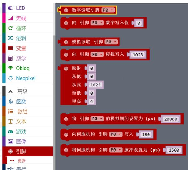
STEP2：当运动传感器检测到有人经过时，实现舵机转动 100° 并且 micro:bit 显示 “O”；否则，舵机旋转 0° 并且 micro:bit 显示 “X”。
