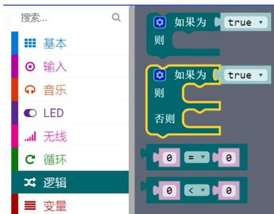
STEP4: 需要用到的指令结合在一起，实现：当按下按钮的时候，外接 LED 小灯被点亮，松开按钮以后，外接 LED 小灯熄灭。
