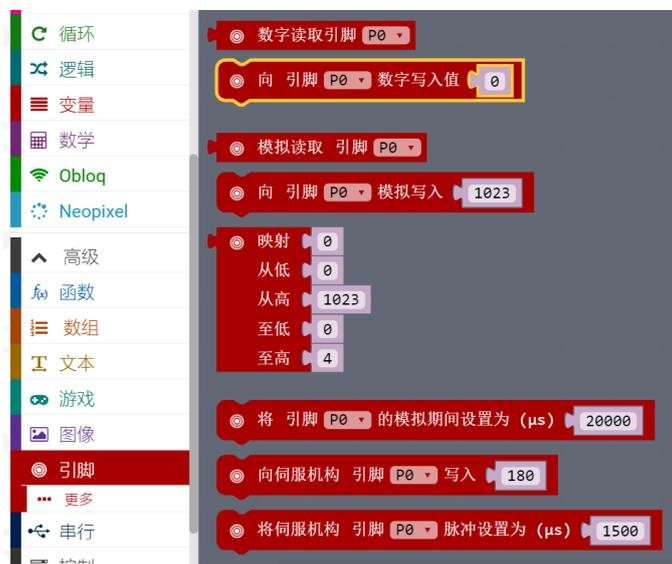
**STEP3:** 将其指令拖动入“无限循环”中，当烧录代码至 micro:bit 小板子时，可以点亮连接在 P1 号引脚的外接 LED 小灯。（拖动后，将 P0 改为 P1）引脚值只有 0 和 1 两种情况，当值为 1 时，表示小灯被点亮；当值为 0 时，表示小灯呈现熄灭状态。
