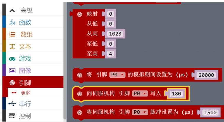
**STEP2:** 如果按钮按下, 实现舵机转动 100° 并且 micro:bit 显示“O”; 否则舵机旋转 0° 并且 micro:bit 显示“X”。
