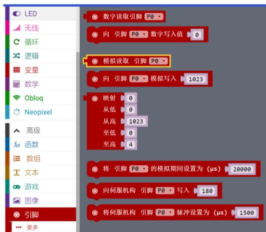
**STEP2:** LED 灯的亮度由 P0 对应的旋钮值决定，将 P0 的值赋值给 P1，可以控制 LED 灯的改变，
