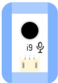
能够通过它来感知外界声音的强弱，编写代码实现声音强弱控制输出模块 LED 小灯的亮灭。
