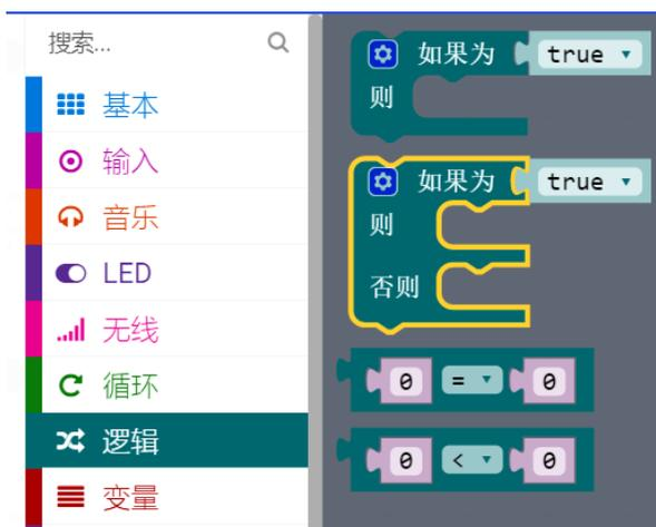
STEP4: 需要用到的指令结合在一起，实现：当按下按钮的时候，外接风扇转动，松开按钮以后，风扇停止转动。
