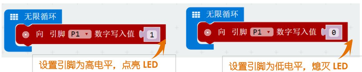
最终程序，下载到 micro:bit 板子中。
