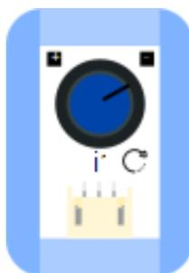
旋钮作为**输入模块**，可以通过旋转不同的角度，传递不同的信号值。旋钮与按钮的区别：按钮处于按下状态时，电路接通，旋钮旋转在一定范围内，电路处于接通状态。
