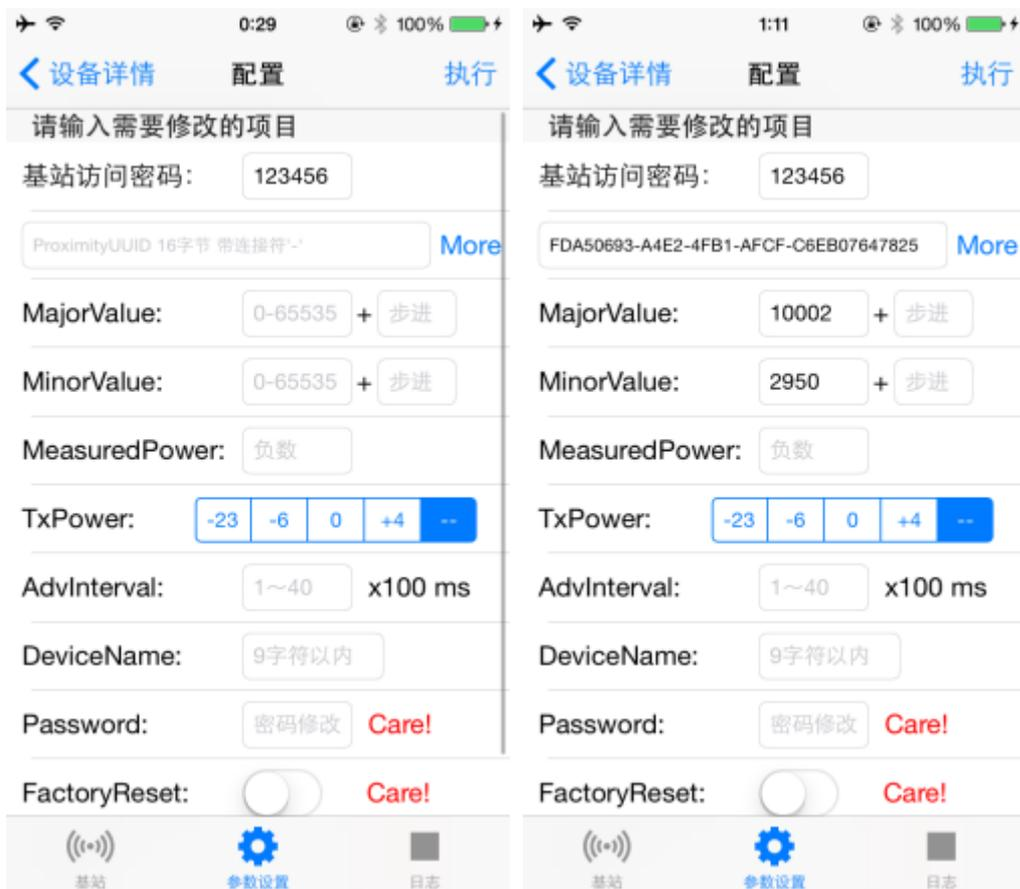
点击 “执行” 按钮, 开始写入参数。屏幕上会显示当前的执行状态, 参数写入结束后, 可点击日志, 查看写入日志。如果某一条写入失败, 请返回重试。
