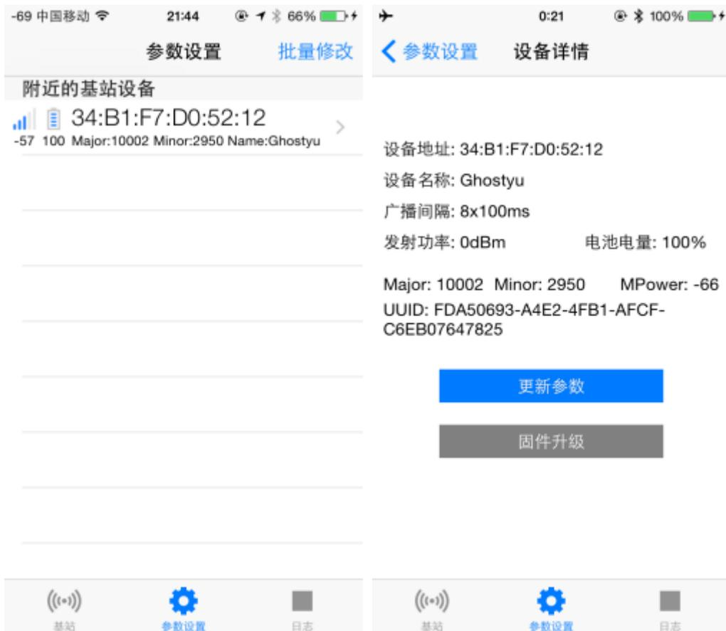
点击按钮“更新参数”，进入配置页面。想要修改基站参数，必须输入正确的基站访问密码，LightBeacon 基站初始密码为“123456”，部署后，请尽快修改密码。下面参数中，留空表示不修改。请只输入要修改的参数。
